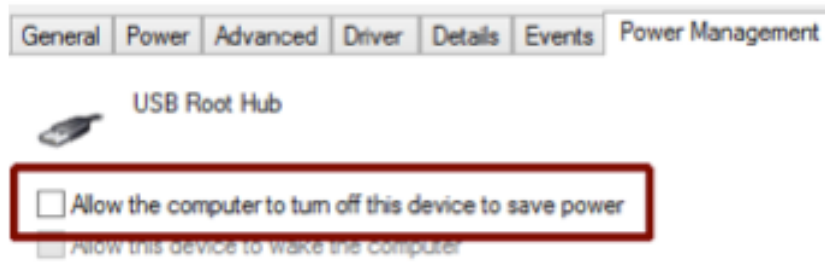
Rys. 6.1.2. Włączanie i wyłączanie trybu oszczędzania energii dla urządzeń USB
